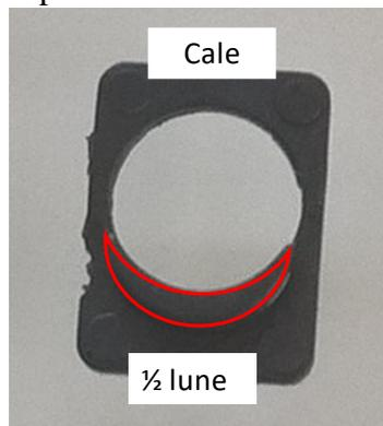
Il faut que la 1/2 lune et les vis soient placées en position basse du berceau
